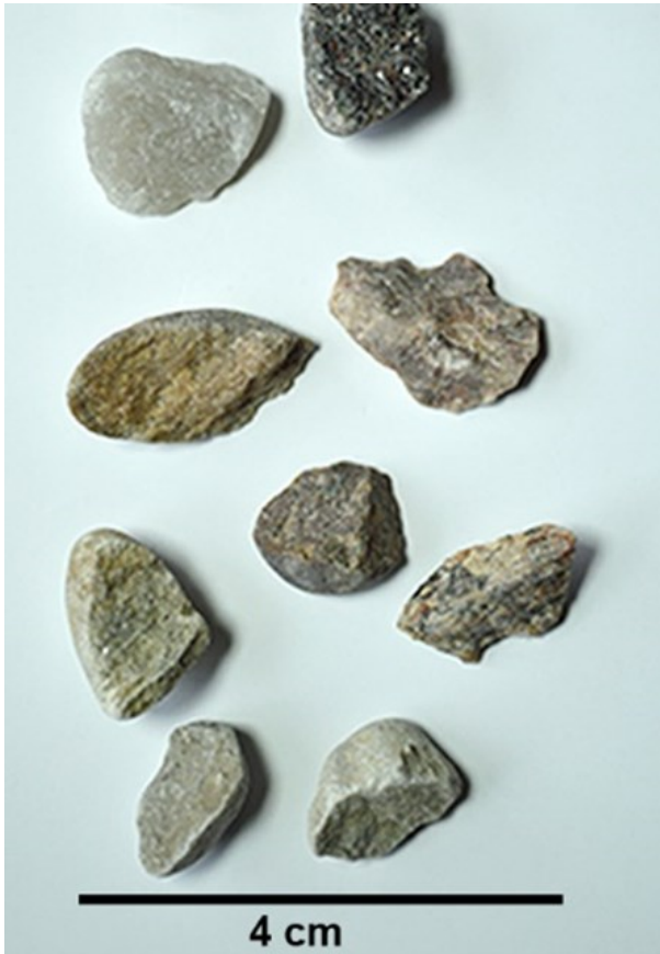
Figur 9. Krossade korn från hammarborrningsens sedimentprover.
